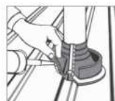
4. Vigye fel a tömítőanyagot, és a Dektite-et formálja rá a tetőlemezre.
