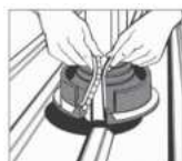
2. A Dektite-et fektesse a csőre és a fémszárat illessze össze (fentről lefelé).
