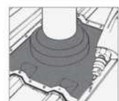
6. Először rögzítse az oldalakat a borda tetején, középről kifelé haladva, folytassa a többi oldalal.
