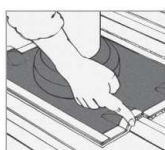
2. Illesse és jelölje a Dektite-et a profilmezén.
