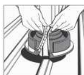
2. A Dektite-et fektesse a csőre és a fémzárat illessze össze (fentről lefelé).
