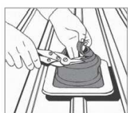
1. Illesse a Dektite-et a csőhöz.
