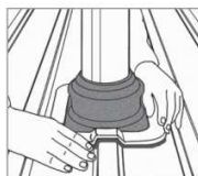
3. A Dektite illessze rá a tetőprofilra.
