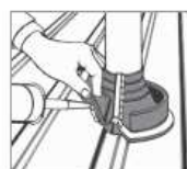
4. Vigye fel a tömítőanyagot, és a Dektite-et formálja rá a tetőlemezzre.
