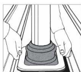
2. Illesse és jelölje a Dektite-t a profilmezén.
