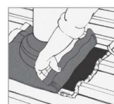
5. Vigye fel a tömítőanyagot és a Dektite-et formázza a tetőprofilra.
