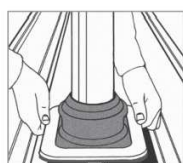
2. Illesse és jelölje a Dektite-et a profilmezén.
