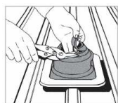
1. Illesse a Dektite-t a csőhöz.
