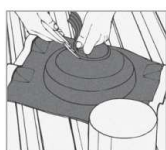
1. Illesse a Dektite-et a csőhöz.
