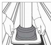
2. Illessze és jelölje a Dektite-et a profilmezemen.
